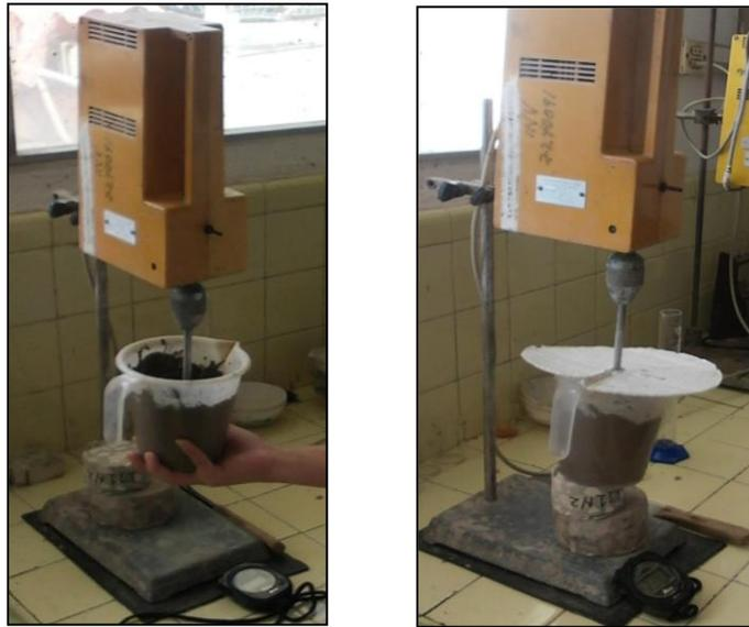
Figura A.6.1 Mezclado y reposo de la pasta de cemento.
