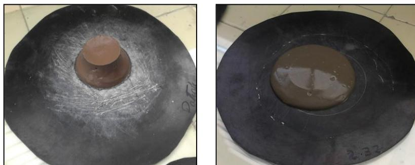
Figura A.6.3 Pastilla de cemento patrón y con aditivo.
