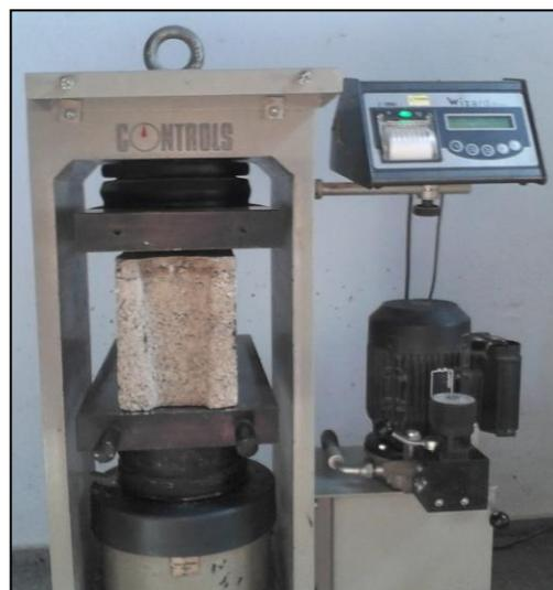
*Figura A.10.1 Prensa digital empleada para el ensayo de resistencia a la compresión de los bloques de hormigón.*
