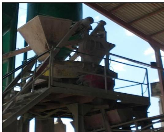
*Figura A.8.3 Mezcladora de las materias primas para la confección de la mezcla de hormigón.*
