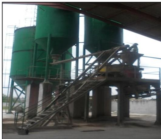
*Figura A.8.2 Tolvas de recepción del agua y el cemento.*
