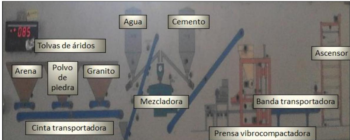
*Figura A.7.1 Diagrama de flujo del proceso tecnológico de bloques de hormigón en la planta automática de Punta Brava “Secundino Guerra” de la provincia de Artemisa.*
