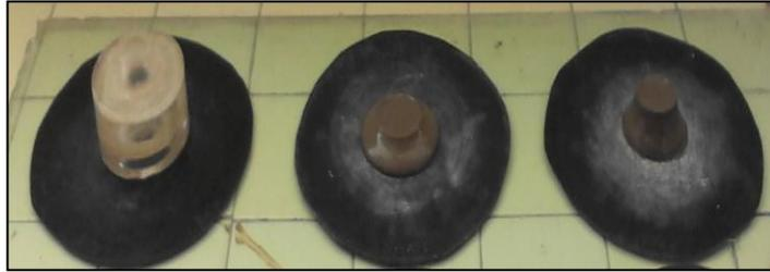
Figura A.6.4 Pastilla de cemento patrón y con varias dosis de aditivo.
