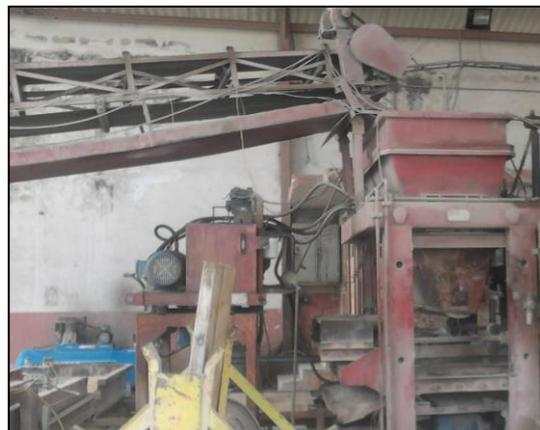
*Figura A.8.4 Cinta transportadora de la mezcla de hormigón hacia la vibrocompactadora.*
