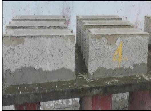
Figura A.9.1 Capping de las muestras de bloques de hormigón patrón y con aditivo.
