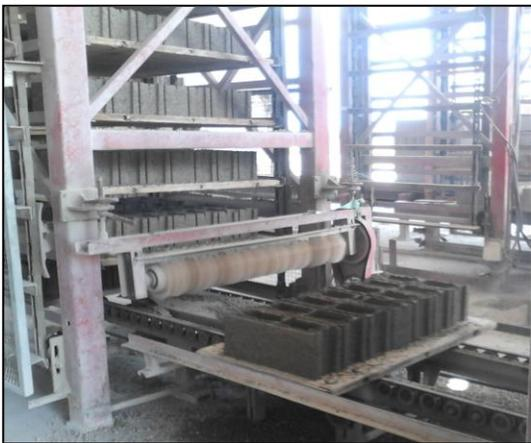
*Figura A.8.6 Cinta transportadora de los bloques hacia los elevadores.*
