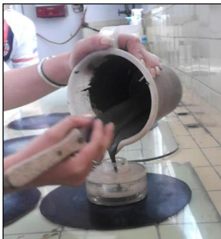
Figura A.6.2 Colocación de la pasta de cemento en el minicono.
