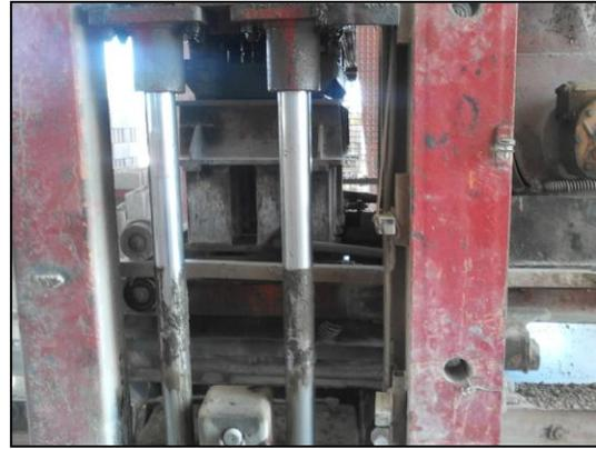
*Figura A.8.5 Equipo vibrocompactador.*
