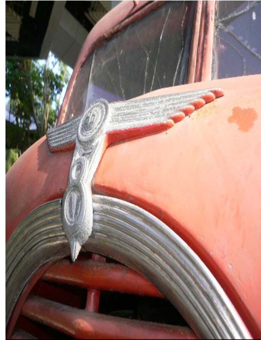
Fig. 6 Resquicios en las uniones metal-metal. Puede presentarse la corrosión atmosférica por resquicio y galvánica por par metálico. Se observan celdas de aireación diferencial por mala preparación superficial.
