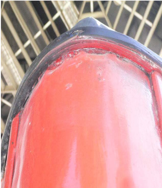
Fig.1 Resquicio en la unión metal-Junta de Goma (polímero), puede presentar corrosión intersticial.
