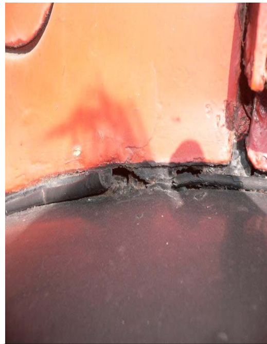
Fig. 10 Resquicio y corrosión por picadura.
