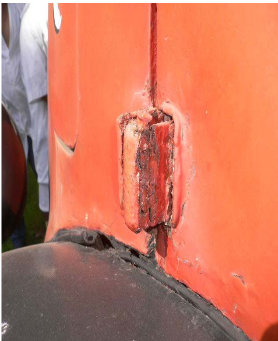
Fig. 11 Resquicio, soldadura irregular y mala preparación superficial. Puede presentar corrosión atmosférica intersticial, por celda de aireación diferencial e interfacial.
