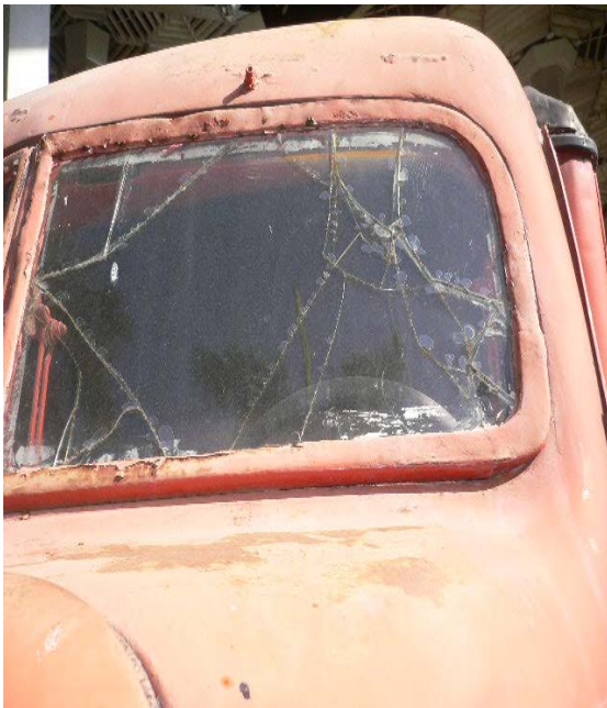
Fig. 7 Resquicio, celda de aireación diferencial y corrosión interfacial.
