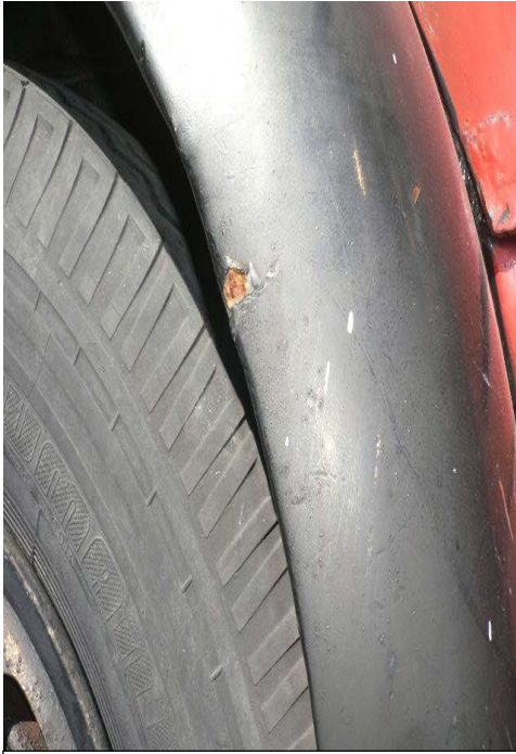
Fig. 17 Mala preparación superficial. Corrosión por celdas de aireación diferencial e interfacial.
