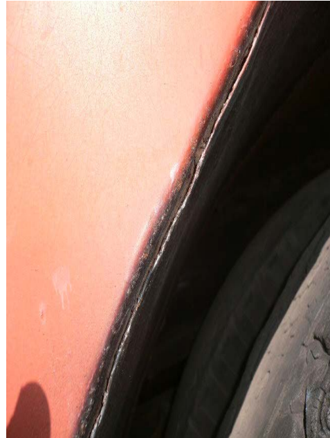
Fig. 26 Resquicios en la unión metal-goma. Corrosión intersticial.
