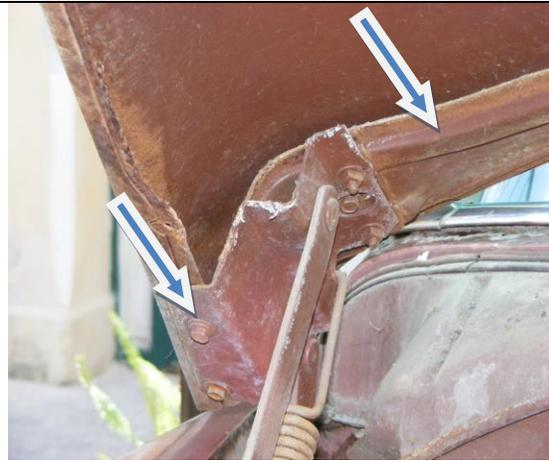
**Fig. 7** Problemas de accesibilidad y Conexión con pernos en el capó. Componente hueco en refuerzos del capot. Presencia de resquicios en la zona. Corrosión intersticial.
