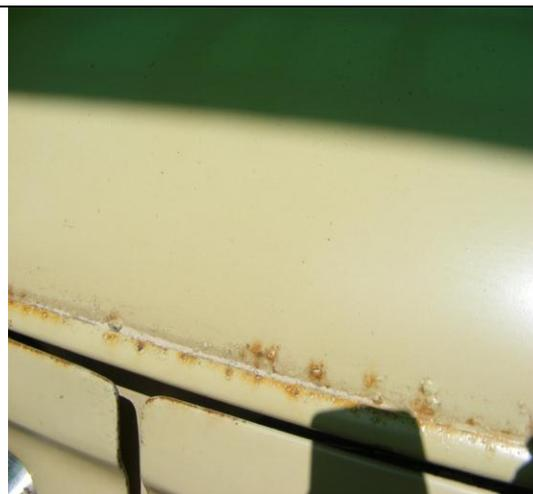
**Fig. 17** Irregularidades en la superficie de la soldadura. Presencia de celdas de aireación diferencial encima de la puerta.
