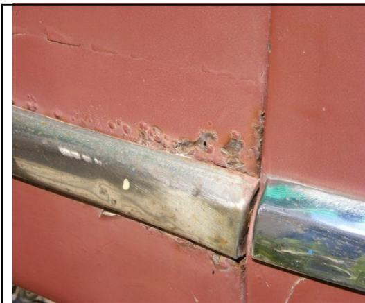
**Fig. 4** Par metálico creado por la unión de los cintillos de acero inoxidable con la estructura de acero al carbono del carro. Pieza de componente hueco. Corrosión por par metálico y por picadura.
