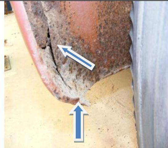
**Fig. 14** Guardafangos con problemas en los bordes y resquicios. Presencia de corrosión por celdas de aireación diferencial e interfacial.
