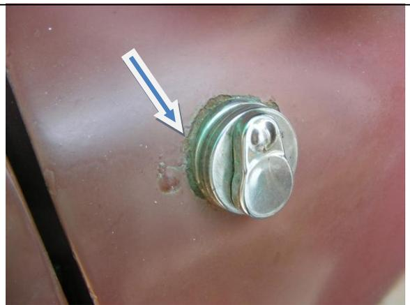
**Fig. 5** Par metálico creado por la unión del llavín con la puerta delantera del auto. Corrosión por par metálico.
