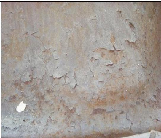
**Fig. 8** Problemas en la preparación superficial por dentro de la tapa del maletero. Corrosión interfacial.
