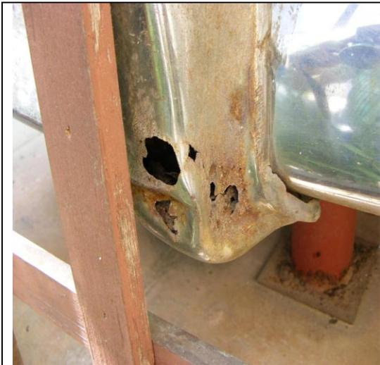
**Fig. 18** La defensa delantera del auto de acero inoxidable es un componente hueco con presencia de corrosión por picadura.
