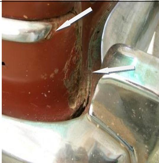
**Fig. 12** Irregularidades en la superficie de la soldadura cerca de la defensa delantera. Se puede apreciar también celdas de concentración y par metálico.
