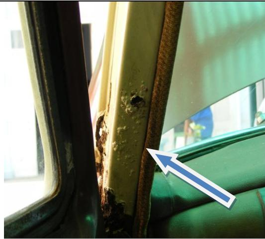
**Fig. 15** El marco que se encuentra a lo largo del parabrisas es un componente hueco donde la corrosión comienza de adentro hacia fuera, existiendo problemas de preparación superficial. Celdas de concentración y corrosión interfacial.
