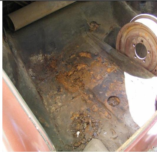
**Fig. 11** EL maletero del auto representa un área cerrada con acumulación y depósito se aprecia la corrosión por celdas de aireación diferencial.
