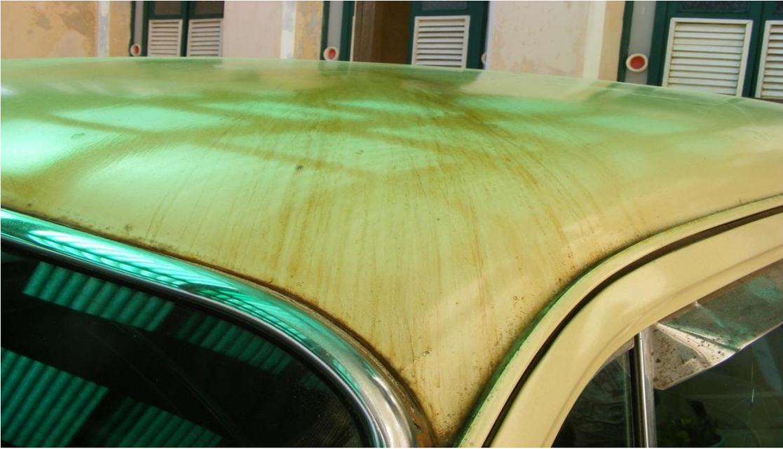
**Fig. 3.1** *Techo del auto de José Antonio manchado por celdas de aireación diferencial formadas por goteras que caen.*
