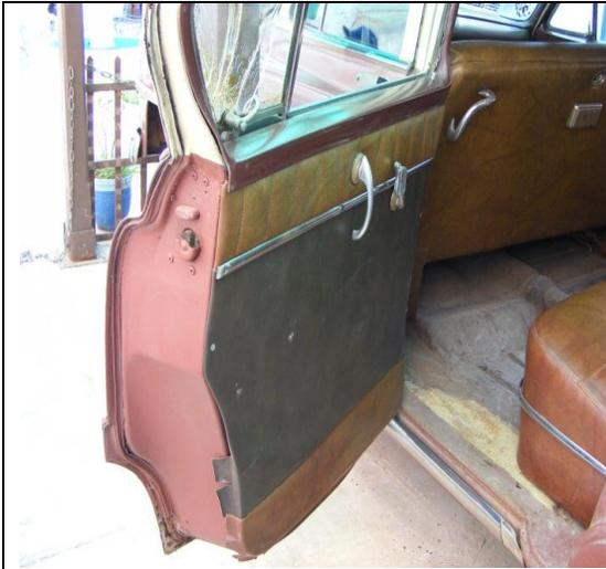
**Fig. 10** La puerta es un área cerrada donde ocurre de adentro hacia fuera el ataques por corrosión. Como la puerta no tiene drenaje en la parte inferior existe acumulación y depósito.
