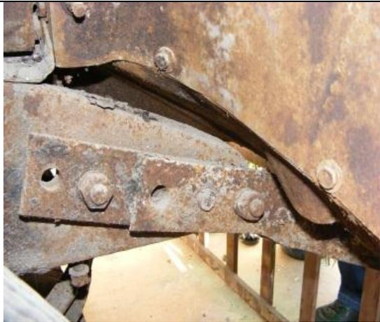
**Fig. 6** Solape, conexión con pernos y bordes en el chasis. Presencia de resquicios en esta zona. Corrosión intersticial y presencia de celdas de concentración.
