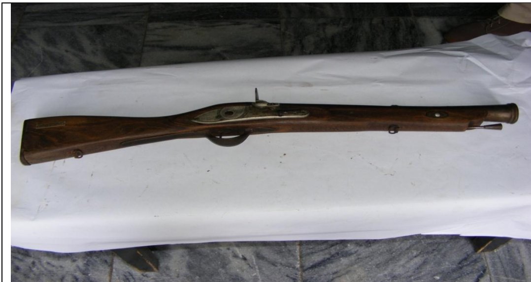
fig.11 Fusil "Trabuco Español". Modelo construido en 1810. De abancarga de balines. Calibre 44. Acero y madera.
