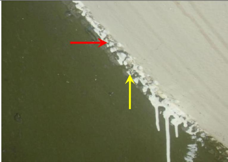
**Fig. 7:** Imperfecciones en la superficie de la soldadura irregular (flecha amarilla), presencia de resquicios e intersticios (flecha roja). Se presenta la corrosión electroquímica atmosférica, mojada, corrosión en resquicios.
