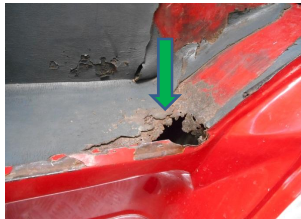
Fig. 20. Resquicios y zona de acumulación de depósito, humedad y mala preparación superficial (verde). Presenta corrosión electroquímica atmosférica húmeda, en resquicios, por celdas de aireación diferencial, interfacial y picadura.
