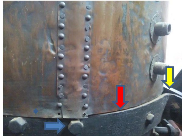
Fig17. zona de acumulación de depósito (amarilla), resquicios (roja), pernos (azul). Presenta corrosión electroquímica atmosférica húmeda, en resquicios y galvánica por par metálico.
