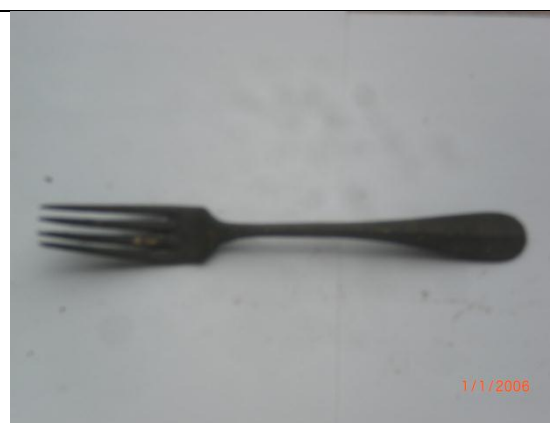
Fig. 46. Tenedor de Alpaca Cafetal La Dionisia, Canimar, Matanzas (siglo 19). Presenta corrosión electroquímica atmosférica generalizada.
