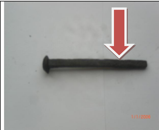
Fig. 39. Clavo. Presenta problemas con los bordes. Corrosión electroquímica atmosférica generalizada.
