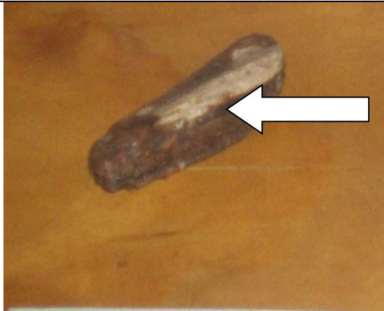
Fig. 27. Navaja con conchas de hueso Cueva El Grillete, Limonar, Matanzas (siglo 19). Acero al carbono. Presenta problemas de resquicios entre las conchas y el metal. Corrosión en resquicios
