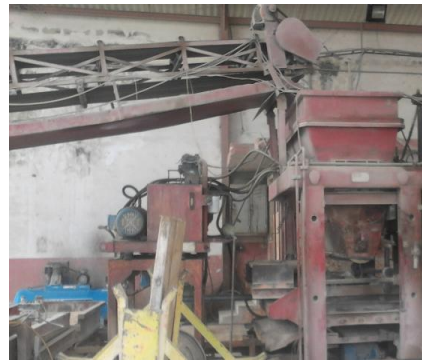
Figura A.9.4 Cinta transportadora de la mezcla de hormigón hacia la vibrocompactadora
