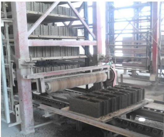
Figura A.9.6 Cinta transportadora de los bloques hacia los elevadores. Figura A.9.7 Elevador de bloques enviados hacia el cuarto de curado.
