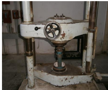
Fig. A.10.1. Prensa hidráulica para la rotura de los bloques de hormigón
