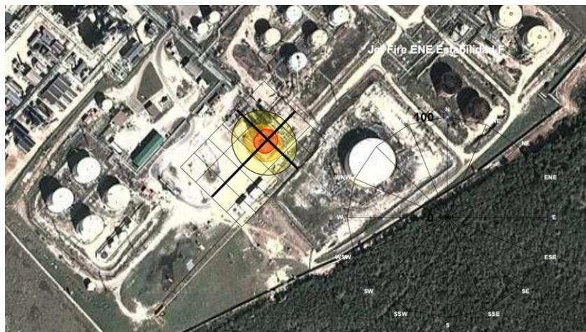
**Fig. 3.15:** Áreas de atmósferas peligrosas del *Jet Fire* en condiciones de Calma en la SES.
